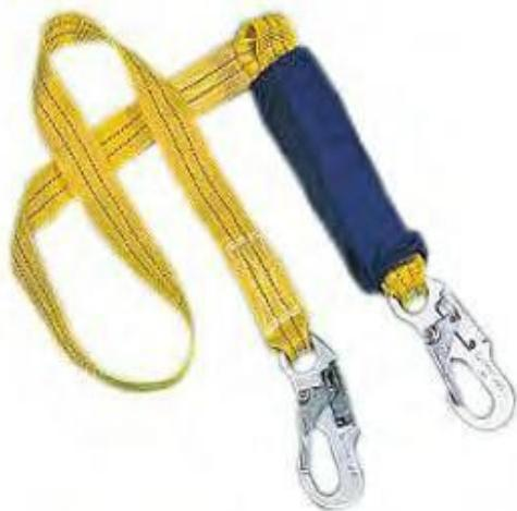
**ESLINGA DE POSICIONAMIENTO:** Elemento de cuerda, cintas, cable u otros materiales con resistencia mínima de 5.000 libras (22,2 kilonewtons – 2.272 kg) que puede tener en sus extremos ganchos o conectores que permiten la unión al arnés del trabajador y al punto de anclaje, y que limita la distancia de caída del trabajador a máximo 60 cm. Su función es ubicar al trabajador en un sitio de trabajo, permitiéndole utilizar las dos manos para su labor.
