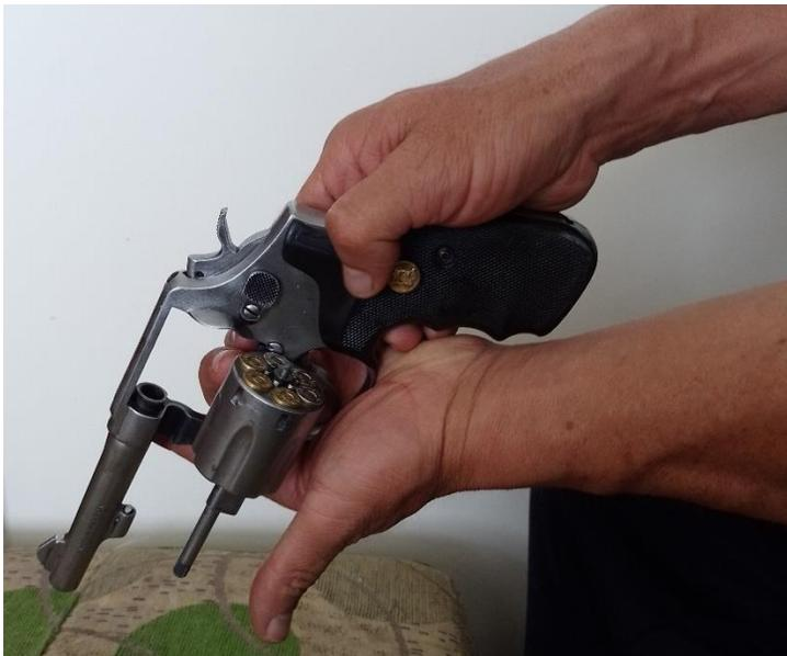
Si el revolver tiene cartuchos en los alveolos del tambor retirarlos utilizando la varilla extractora.
