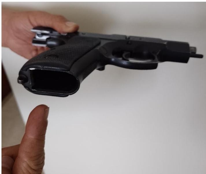
Llevar la corredera hacia atrás y colocar hacia arriba el reten de la corredera para inspeccionar de forma visual la pistola por la ventanilla de eyección, que no se encuentre un cartucho alojado en la recámara ni que se encuentre sostenido por la holgura del culote en la uña extractora.
